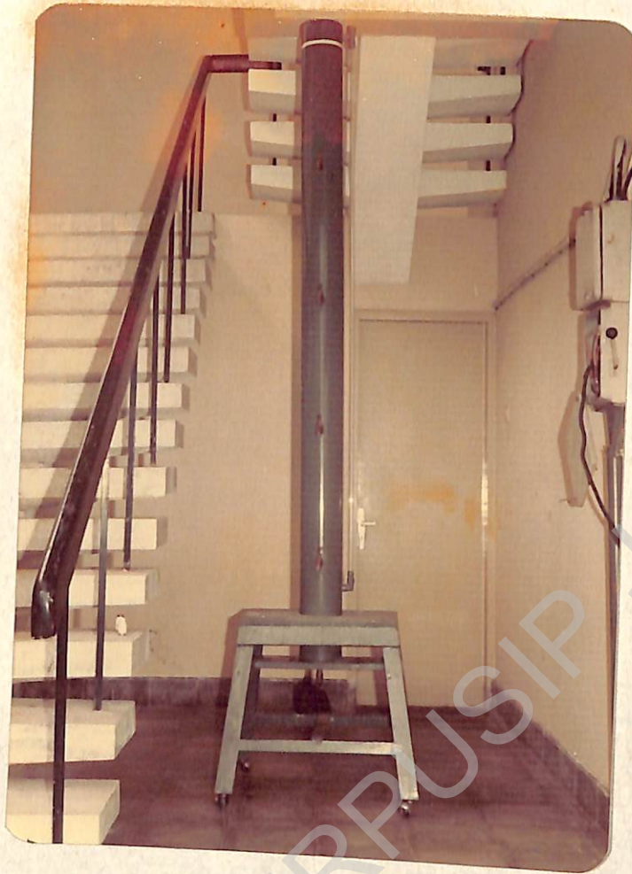
Photo III-1 : Kolom pengendap, yang digunakan untuk percobaan.
